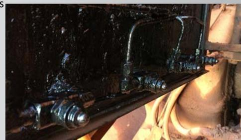
Les buses de pulvérisation de ce système de lubrification à engrenage découvert restent propres et ne se bouchent pas lors de l'application du Pyroshield.
