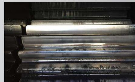
Le Pyroshield 9011, transparent et fluide, lubrifie ces engrenages découverts des broyeurs à billes, facilitant ainsi le contrôle visuel par l'opérateur au moyen d'une lumière stroboscopique pendant le fonctionnement.
